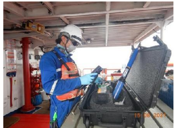
ภาพถ่ายที่ 1 การตรวจวัดความโปร่งใส สีของน้ำทะเล เครื่องมือวัดความเป็นกรด-ด่าง อุณหภูมิ ความเค็ม และออกซิเจนละลาย
