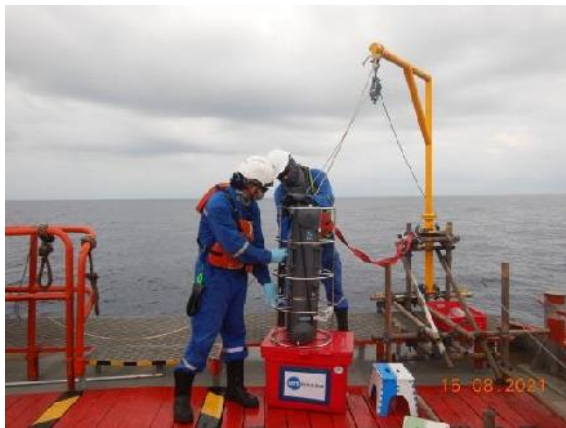
ภาพถ่ายที่ 1 การตรวจวัดความโปร่งใส สีของน้ำทะเล เครื่องมือวัดความเป็นกรด-ด่าง อุณหภูมิ ความเค็ม และออกซิเจนละลาย
